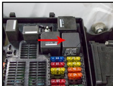
04-10 年捷豹XJ系列 继电器位于车辆右侧的发动机舱内。
